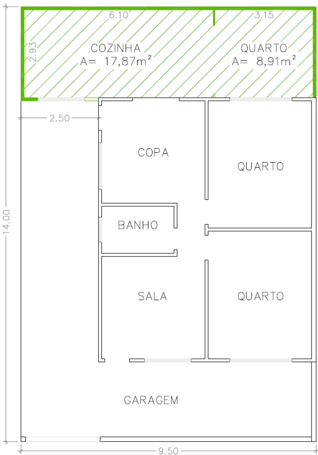
5. Croqui do imóvel, incluindo ampliação.
