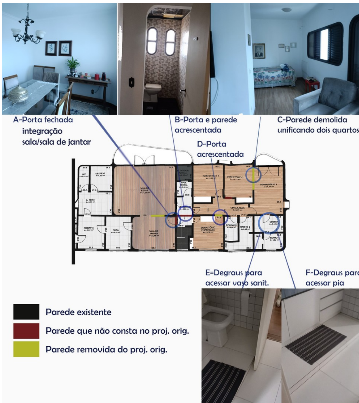
Fig. 32 Alterações na planta
